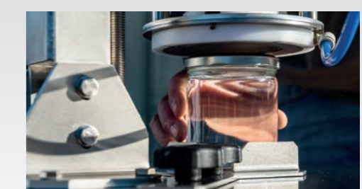
■ Couvercles twist-off métalliques du T038 au T0110 par outillage interchangeable
