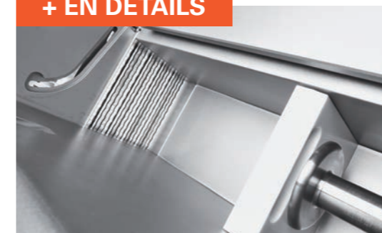
■ Pré-compression latérale, finement dosée
