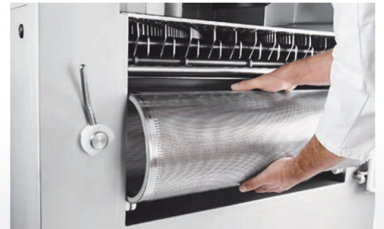
■ Préparation de saumure: filtrage de la saumure par filtre rotatif
