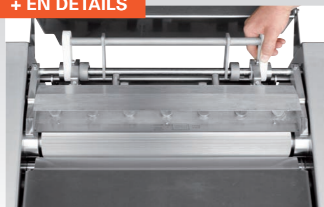
■ Changement de lame rapide sans outillage (option)
