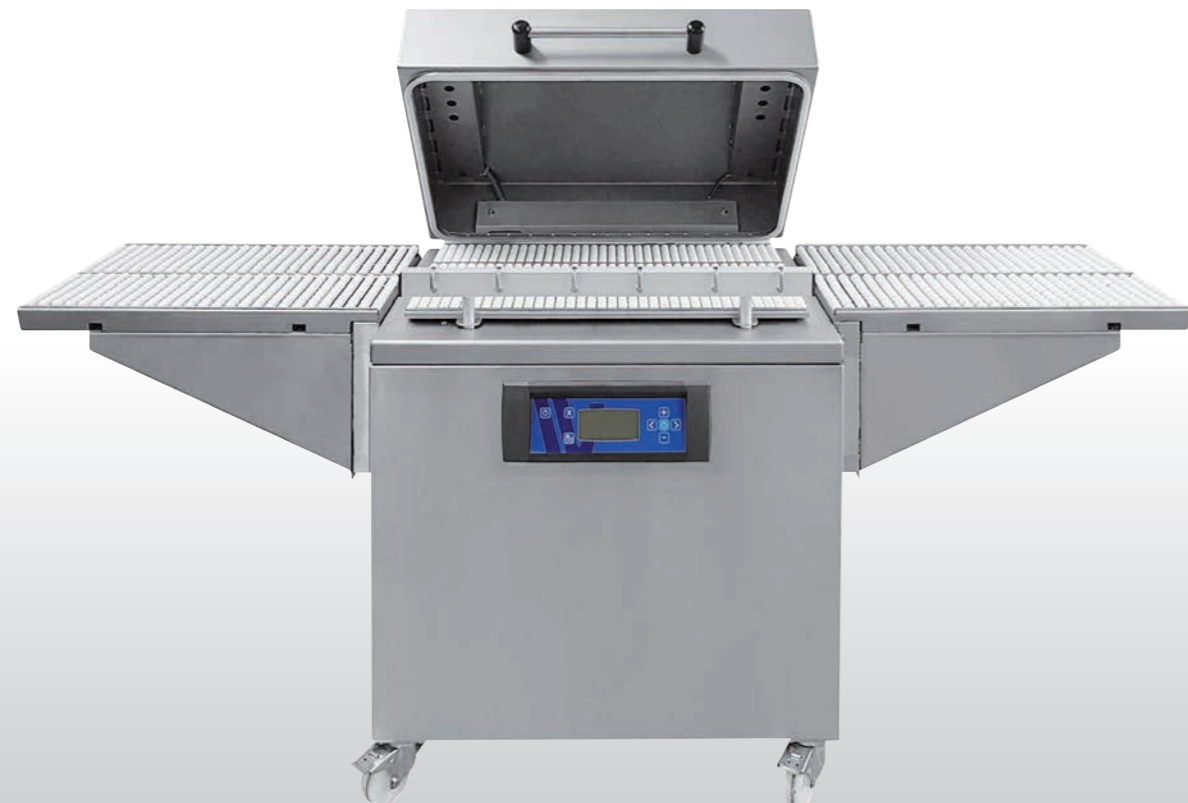
■ Machine sous-vide - Simple cloche avec rouleaux d'amenée, de transfert et d'évacuation
