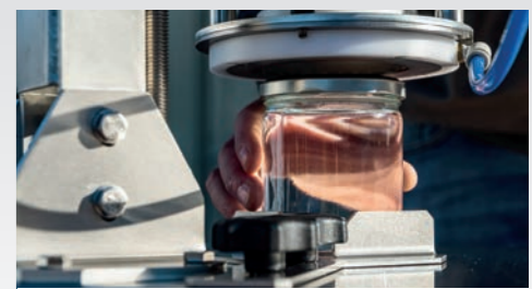
■ Couvercles twist-off métalliques du T038 au T0110 par outillage interchangeable
